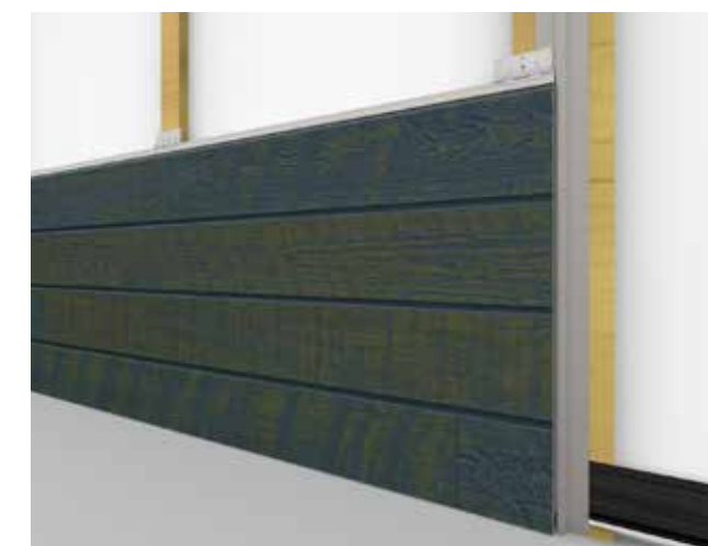
EX series 16 x 455 x 3 030 mm på lodrät traditionell underkonstruktion av trä eller MolaVent stål. Monteras på max. cc 600 mm.
